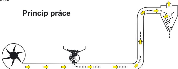
Pouze dva pohyblivé díly – ventilátor a dávkovač! Ventilátor produkuje výkonný proud vzduchu v potrubí. Dopravovaný materiál vstupuje do potrubí buď prostřednictvím injektoru nebo rotačního dávkovače. Dopravní potrubí se připojuje na výstup injektoru nebo dávkovače. Pomocí rozbočovačů lze potrubní systém rozvětvit a materiál dopravovat na více míst.
